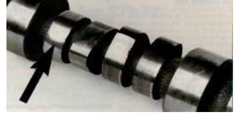
Resim 1: Yalnızca Motor Yağı Yıpranmış Kam Lot
